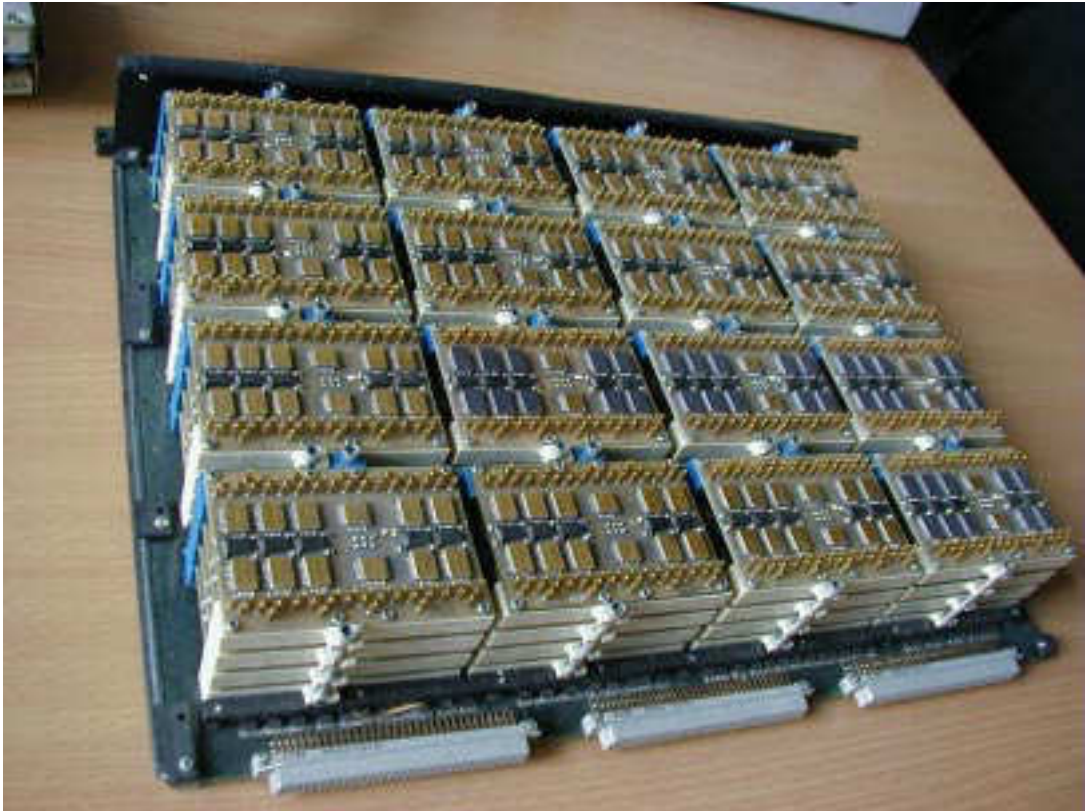
Speicherboard Cyber 205: 2 MB SECCDED, Kaufpreis 500.000 DM
