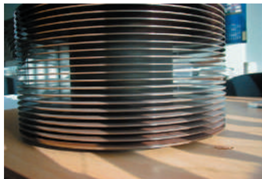
1978: Festplatte 600 MB. Größenvergleich: Die Büroklammer unten rechts
